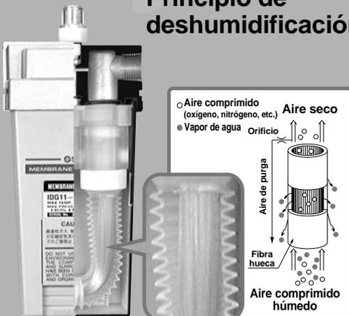
**El secador de aire de membrana utiliza fibras huecas compuestas de una membrana macromolecular que permite el paso del vapor de agua fácilmente pero dificulta el paso del aire (oxígeno y nitrógeno).**
